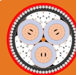
**ARMOURING CAN PROTECT AGAINST MECHANICAL DAMAGE WHEN BURIED DIRECT IN THE GROUND.**
